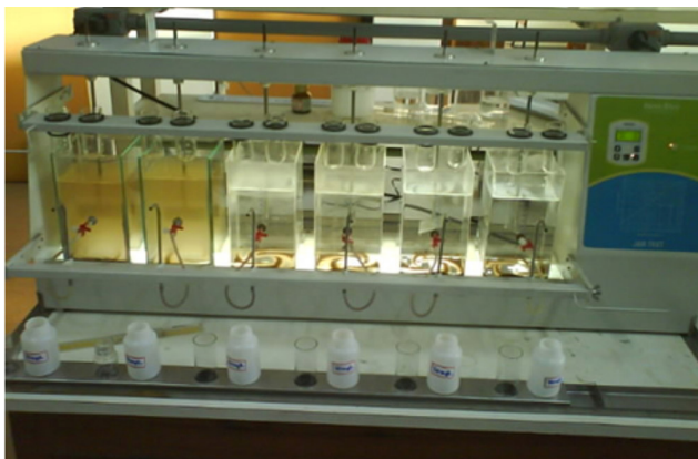
Figura 1. Equipamento Jar test utilizado para simular o tratamento por clarificação
