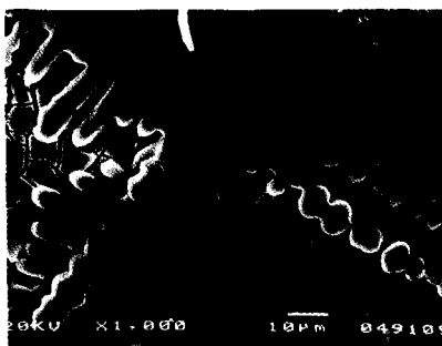
Figura 6. Microscopia eletrônica de géis de SnO 2 , evidenciando a formação de estruturas dendríticas.
