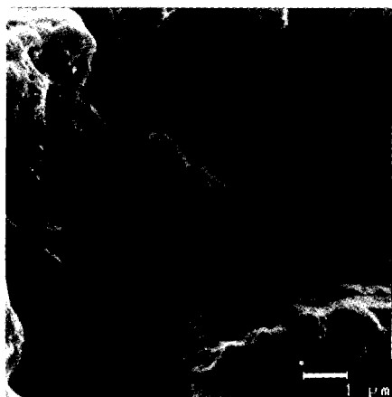
Figura 4. Micrografia de MEV do compósito fosfato de cálcio/colágeno, numa proporção 20:1 (m/m), aumento de 10.000x.
