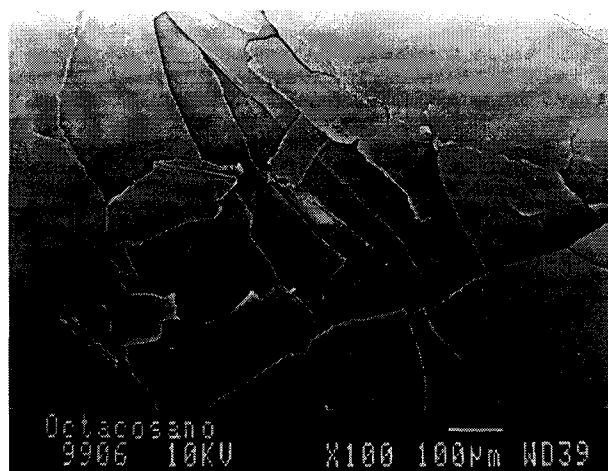
Figura 6. Eletromicrografia dos cristais de n-octacosano antes do tratamento magnético ampliado 100 vezes.
