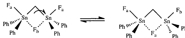
Figura 11. O processo de troca intramolecular que ocorre em solução do complexo [(\text{Ph}_2\text{FSn})_2\text{CH}_2\text{F}]^- quando se eleva a temperatura.
