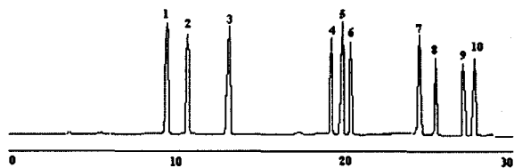
Figura 1. Cromatograma das 2,4-dinitrofenildrazonas dos padrões de aldeídos e acetona na coluna Shimadzu C-18 (25 cm x 4,6 mm; 5 µm). Vazão de 1,0 mL/min. Gradiente de eluição: metanol-água (65:35 v/v) durante 15 min, então metanol ; água (75:15 v/v) em 18 min, metanol-água (85:15 v/v) em 20 min, metanol-água (75:25 v/v) em 25 min, metanol-água (70:30 v/v) em 30 min e metanol-água (65:35 v/v) em 35 min. Detecção no UV a 365 nm. Identificação dos picos: 1=formaldeído, 2=5-hidroximetilfurfural, 3=acetaldeído, 4=acroleína, 5=furfural, 6=acetona, 7=n-butiraldeído, 8=benzaldeído, 9=n-valeraldeído e 10=isovaleraldeído.
