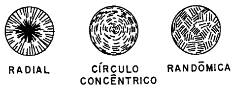
Figura 3. Modelos de estruturas transversais de fibras de materiais tipo PAN e piche 3 .
