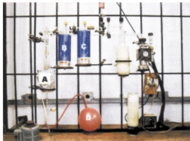
Figura 1. Linha de vácuo utilizada para recuperação de cobre metálico a partir do óxido de cobre. A- Forno à 450 °C; B- Armadilha de gelo seco e etanol à -73 °C; C- Armadilha de nitrogênio líquido à -196 °C; D- Balão de hidrogênio gasoso
