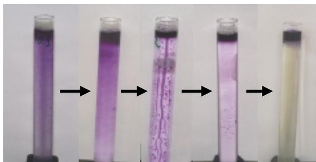
**Figura 1.** Sequência de fotos da separação de fases obtidas para pré-concentração de Co através do Ponto Nuvem. Fase colorida (superior) e transparente (inferior): denominadas de fase rica e fase pobre em tensoativo, respectivamente. As condições experimentais foram aquelas obtidas a partir do Experimento 1, segunda parte - pré-concentração. O tempo total envolvido, após a adição do HCl, foi ca. de 3 min
