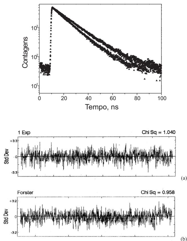
**Figura 4.** Decaimento e ajuste para a 9-aminoacridina/violeta de cresila em metanol, (a) ausência de violeta de cresila,  $\tau_0 = 13,89$  ns e (b)  $8,33 \cdot 10^{-4}$  M de violeta de cresila,  $\Gamma = 0,286$ ,  $T = 298$  K
