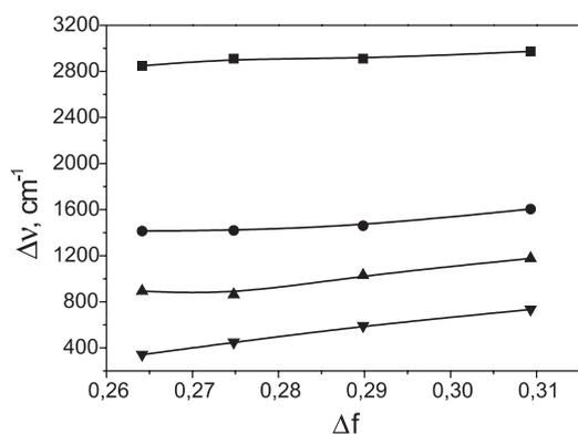
Figura 2. Gráfico de deslocamento de Stokes em função do parâmetro de polaridade do solvente para os corantes 9-aminoacridina (■), proflavina (●), safranina (▲) e cristal violeta (▼),  $T = 298\text{ K}$
