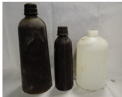
Figura 2. O acondicionamento do ácido fluorídrico: frasco de ebonite, 1920 (à esquerda); frasco de baquelite, 1926 (ao centro); frasco de polietileno, 1996 (à direita)
