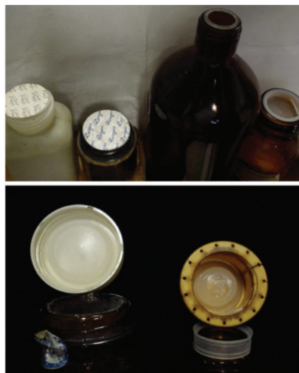
Figura 6. Alguns exemplos de vedação de reagentes: acima: reagentes sólidos (anos 1960) contendo um lacre branco colado à boca do recipiente, e reagentes líquidos (anos 1970) contendo um disco plástico que se ajusta à abertura do frasco por pressão; abaixo: reagentes líquidos (anos 1950) em cuja parte interna da tampa rosqueada apõe-se um vedante em plástico ajustado à abertura do recipiente
