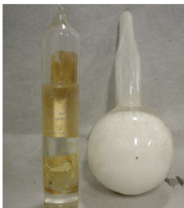
Figura 5. Dois produtos extremamente reativos frente à umidade selados em ampolas de vidro: tetracloreto de silício (à esquerda, 1920) e trióxido de enxofre (à direita, 1933)
