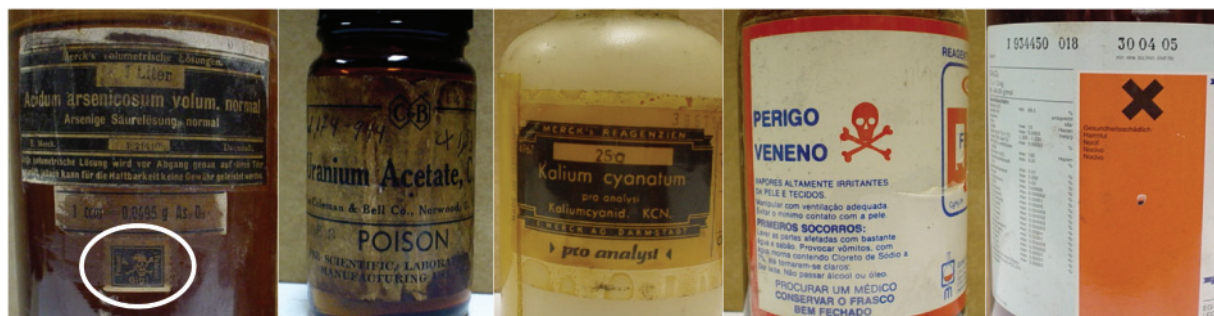
Figura 15. Reagentes venenosos e as advertências de perigo. Da esquerda para a direita: ácido arsenioso ( 0,1 \text{ mol L}^{-1} ), 1929; acetato de uranila, 1944; cianeto de potássio, 1963; fenol, 1980; diclorometano, 2001
