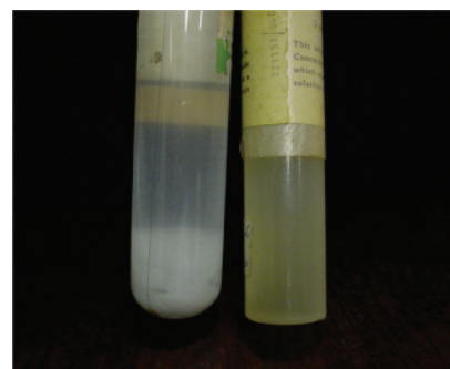
Figura 3. A ampola de NaOH (0,1 mol L -1 ) em embalagem de vidro (1962, à esquerda) e em embalagem plástica (1972, à direita). Notar a formação de depósito branco na embalagem da esquerda, fruto do ataque da base ao vidro
