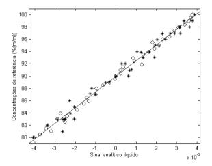
Figura 6. Escalar NAS contra as concentrações de referência, (○) amostras de calibração, (★) validação e (—) o modelo PLS com 3 variáveis latentes em sua forma pseudounivariada
