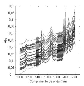
Figura 2. Espectros NIR de reflectância difusa para as replicatas do conjunto de calibração
