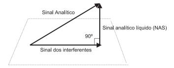
Figura 1. Representação geométrica do vetor de sinal analítico
