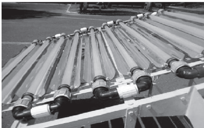
Figura 2. Detalhe da superfície refletora de um reator CPC
