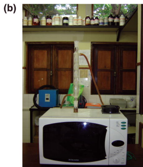
Figura 4. Adaptação de forno de microondas doméstico para reações sob refluxo. (a) diagrama esquemático das furações da cuba e revestimento dos furos com anel de cobre. (b) foto frontal do equipamento de microondas adaptado
