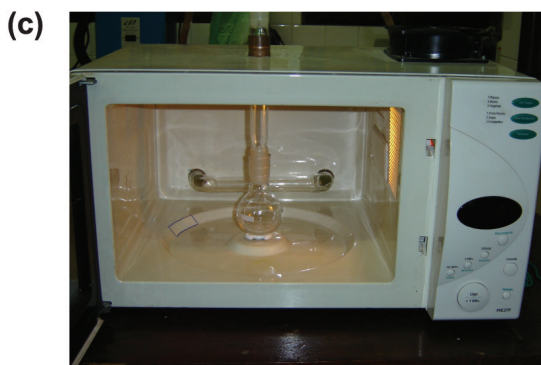
Figura 1. Sistema moderador de ondas. (a) Tubo em “U” e adaptador 24/40 para balão e condensador de refluxo. (b) Foto da face posterior do forno. (c) Tubo em “U” e balão de reação conectados ao forno de microondas
