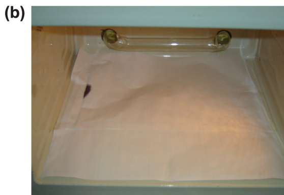
Figura 3. Mapeamento do forno de MO usando papel de fax termo-sensível. (a) Forramento total da base com folha de papel de fax. (b) Ponto ótimo de irradiação no interior do forno
