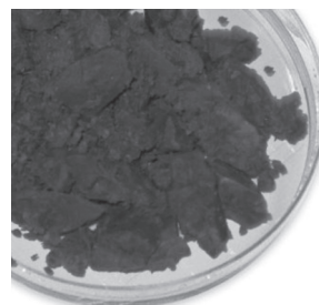
Figura 1. Resíduo proveniente da galvanização
