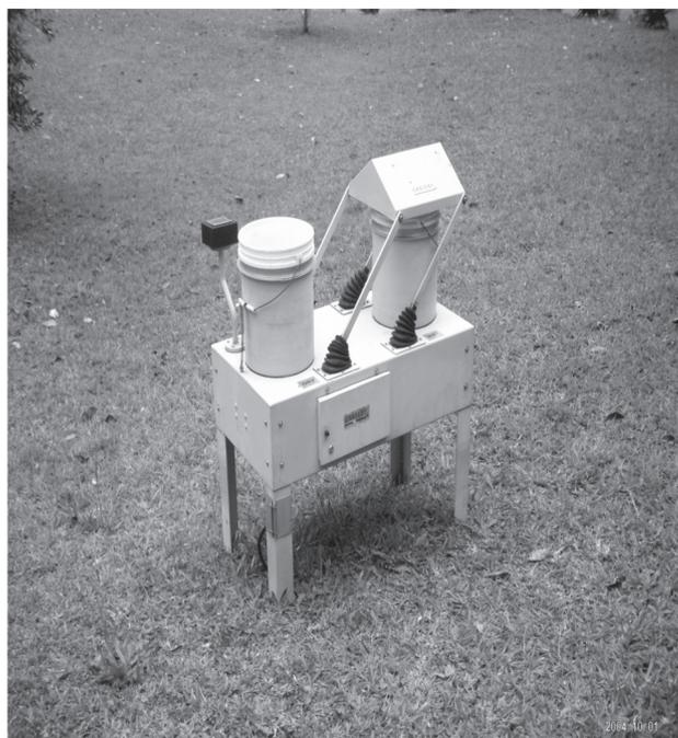
Figura 1. Coletor automático de deposição úmida e seca instalado na sede do Parque Nacional da Serra dos Órgãos (Teresópolis, RJ)
