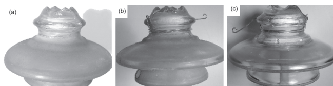
Figura 7. Isolador de vidro: a) como retirado da RD; b) após uma primeira lavagem com RFC; c) após a segunda lavagem, com procedimento manual para a retirada dos poluentes depositados
