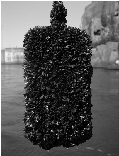
Figura 3. Biofouling de L. fortunei (mexilhão dourado) na superfície de um dos CPs, após 12 meses de imersão no reservatório da UHE GJR
