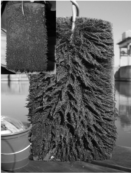
Figura 2. Biofouling de hidrozoário C. caspia sobre um dos CPs imersos no reservatório da UHE GJR por 8 meses. Na imagem menor, o mesmo CP após 3 meses de imersão
