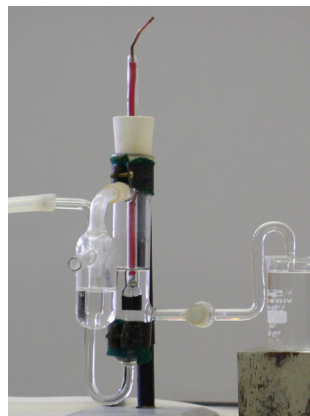
Figura 4. Foto do eletrodo de hidrogênio utilizado em aulas experimentais no IQUSP e construído segundo indicações de Findlay 34
