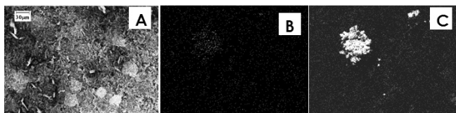
Figura 3. Micrografia de superfície do EM Ni/Pd (A) e composição elementar do níquel (B) e paládio (C) no EM Ni/Pd
