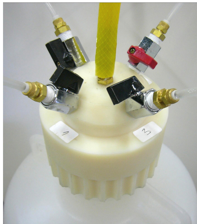
Figura 2S. Tampa de nylon (manifold) utilizado na bombona de 20 L
