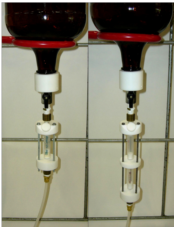
Figura 1S. Conjuntos de extração para um e dois cartuchos (in tandem) em linha
