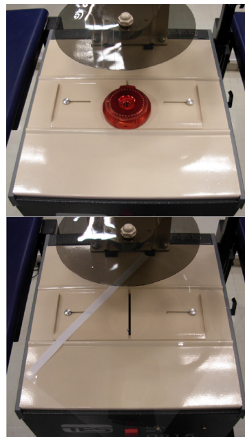
Figura 3. Fotografia da base do retroprojektor configurado para as demonstrações de birrefringência linear em uma lâmina de quartzo com suporte goniométrico (superior) e em um filme de transparência para retroprojektor (inferior)
