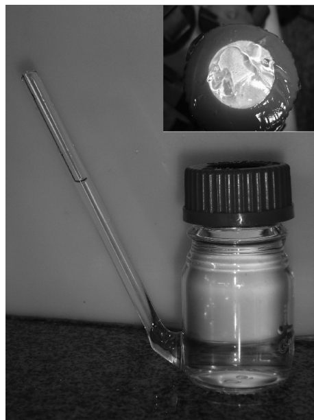
Figura 3. Célula de difusão utilizada nos ensaios de liberação, no detalhe, área exposta para aplicação do US sobre membrana de acetato de celulose
