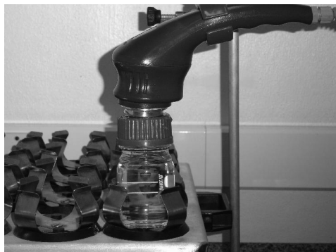
Figura 2. Sistema para aplicação do ultrassom terapêutico in vitro
