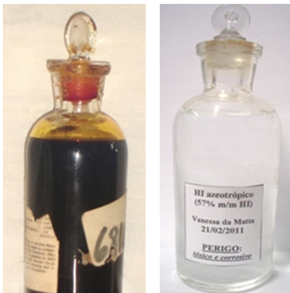
Figura 1S. Aspecto de uma solução de ácido iodídrico (HI), fabricado em 1943, antes (esquerda) e após (direita) tratamento com fósforo vermelho, seguido de destilação do HI azeotrópico
