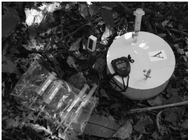
Figura 1. Câmara utilizada para medição do fluxo de óxido nitroso na interface solo-atmosfera
