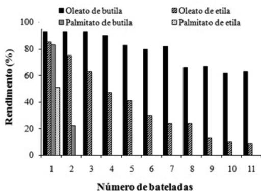
**Figura 3.** Reutilização da lipase Lipozyme RM IM nas reações de síntese de oleato de butila e de etila (a 40 °C) e de palmitato de butila e de etila (a 70 °C), empregando razão estequiométrica dos reagentes ( $R = 1$ ) e 3% (m/m) de enzima. Rendimento determinado por cromatografia em fase gasosa
