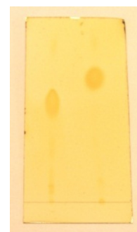
Figura 1S. Cromatografia de camada delgada da matéria-prima (esquerda) e do produto (direita) da reação de transesterificação do óleo de canola (eluído em hexano:éter etílico:HOAc 80:19:1, revelado em I 2 )
