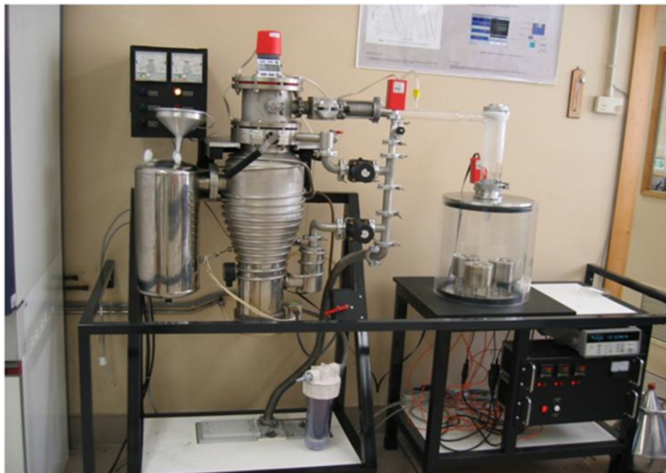
Figura 4S. Sistema de efusão de Knudsen 4
