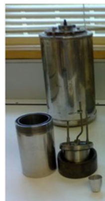
(atrás) Vaso calorimétrico; (à frente da esquerda para a direita) corpo da bomba, cabeça da bomba e cadinho de platina.
