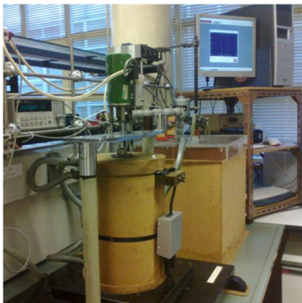
Vista geral do sistema de calorimetria de combustão em bomba estática.
