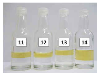
Figura 3. Sistemas ternários, compostos por biodiesel etílico do óleo de girassol, etanol e glicerol, na zona de heterogeneidade, preparados de acordo com a Tabela 3, após separação de fases
