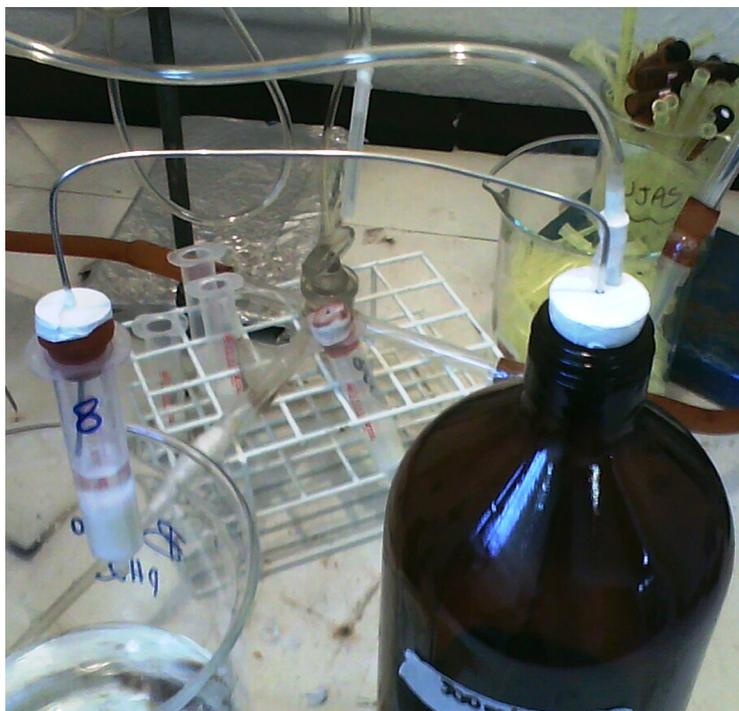
Figura 2S. Foto do equipamento de extração desenvolvido em funcionamento, com destaque as tubulações em aço inox por onde passam as amostras diretamente do frasco de armazenamento para o leito do cartucho de SPE
