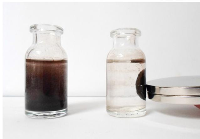
Figura 4. Efecto de un campo magnético externo en fluidos ferromagnéticos
